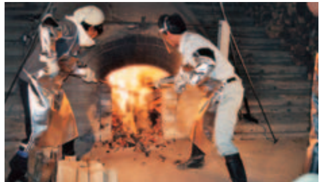
1,000 まで上がりました。 温度を上昇させるため、オキをかき混ぜます。 防護服を着ないと窯の前に立つことができません。
